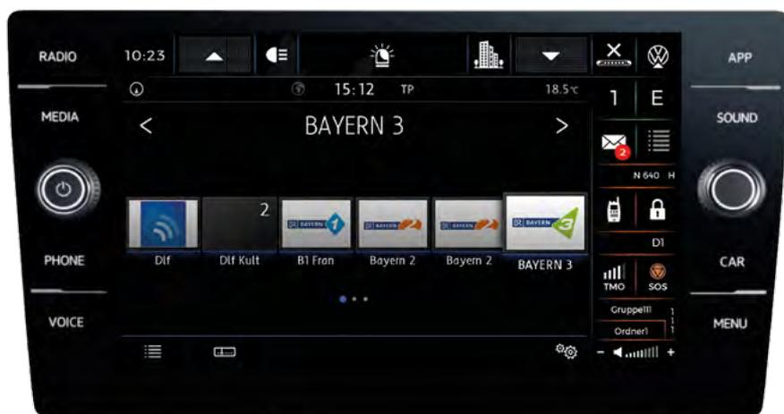
Alles auf einen Blick – mit Hilfe von Alpha-Blending sind während der Benutzung des Serien-Systems (im Bild: Radio) alle wichtigen Statusinformationen des Sonderfahrzeugs zu jeder Zeit sichtbar.
